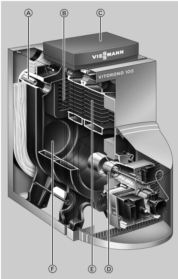
Die Einzelsegmente werden dank elastischer Dichtung dauerhaft heizgasseitig abgedichtet. Die waagerechte Anordnung der Heizgaszüge erlaubt zudem eine vollständige und einfache Reinigung.
