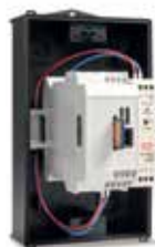
KTS ComLog-Modul Figur 955 02 001, für ModBus über die RS485-Schnittstelle
