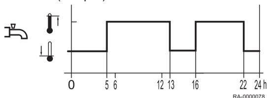
Zeitprogramm 4/TWW: Die Trinkwassertemperatur wird unabhängig von den Zeitprogrammen der Heizkreise zwischen dem Trinkwassertemperatur-Sollwert und dem Trinkwassertemperatur-Reduziert Sollwert umgeschaltet. Dabei wird das Zeitprogramm 4 genutzt.
