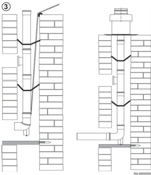
3. Die Abgasleitung wird von oben in den Schacht abgelassen. Dazu ein Seil am Stützfuß befestigen und die Rohre abschnittsweise von oben einstecken. Damit die Bauteile während der Montage nicht auseinander gleiten, muss das Seil bis zur endgültigen Montage der Abgasleitung auf Zug gehalten werden. Sind Abstandshalter erforderlich müssen diese an der Rohrstrecke mind. alle 2 m angebracht werden.
