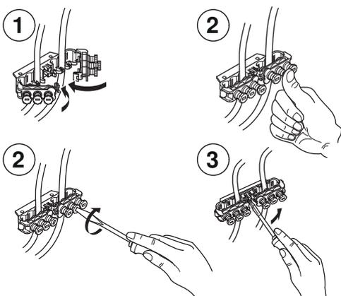
Alle elektr. Leitungen sind in den Zugentlastungen des Schaltfeldes festzusetzen und entsprechend dem Schaltplan anzuschließen.
