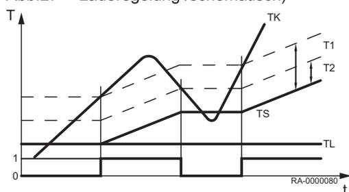
Mit diesen Funktionen wird der Ein- bzw. Ausschaltzeitpunkt der Kollektorpumpe festgelegt. Grundlage ist die Temperaturdifferenz zwischen Kollektortemperatur und Speichertemperatur.
